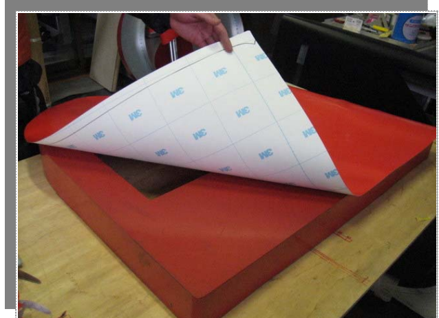
チャンネル文字(大)表面シート貼り
