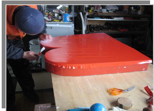
チャンネル文字(大)表面シート貼り
