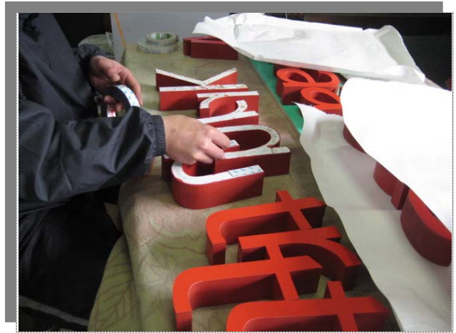
チャンネル文字(小)ベース板取付
