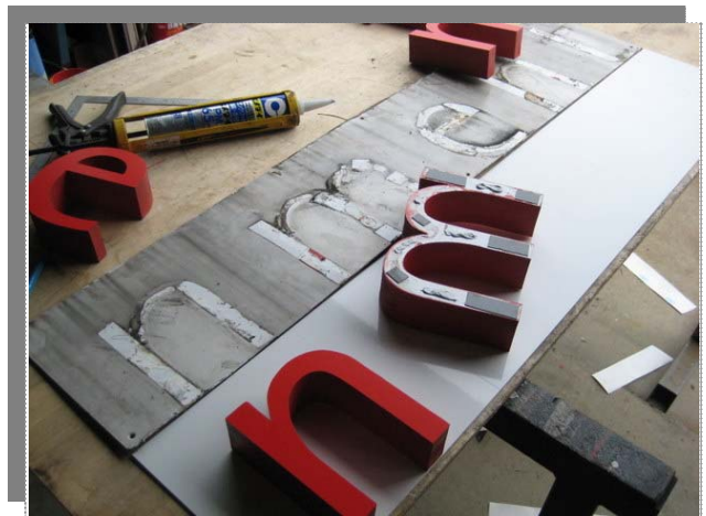
チャンネル文字(小)ベース板取付
